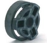
Flexible Kupplungselemente reduzieren das hörbare Geräusch typischerweise um ca. 5dBA und das Beschleunigungs-Drehmoment für die Lastträgheit auf ca. 1/3 des ursprünglichen Wertes. Die Lebensdauer bei ca. 0,9Nm Lastmoment wird mit ca. 1Mio. Zyklen angegeben. Die Flexiblen Kupplungselemente eignen sich für Umgebungstemperaturen bis 50°C und passen für die Baugrößen EC15\*/ EC20 / EC25\* / EC30 (\*reduzierte Lebensdauer wegen Größenunterschied).
