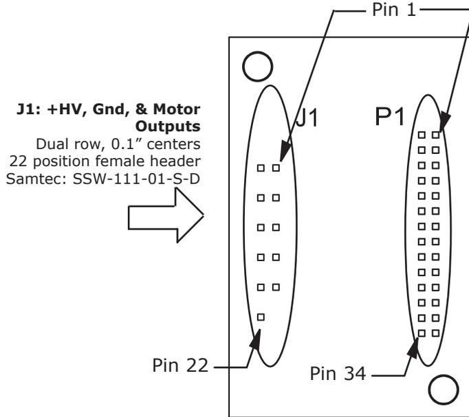
**J1: +HV, Gnd, & Motor Outputs**
