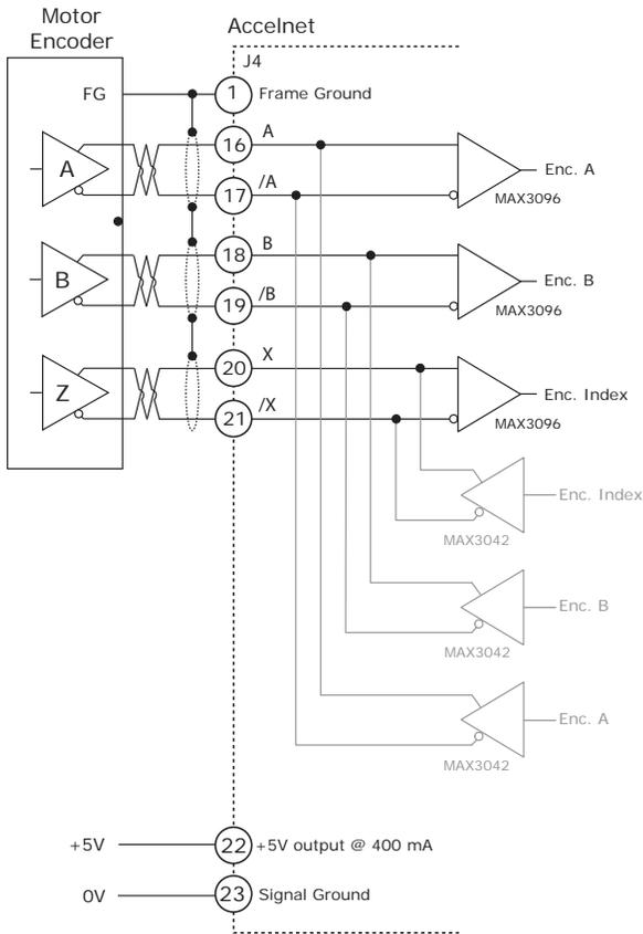
BUFFERED OUTPUTS FROM THE MOTOR ENCODER
