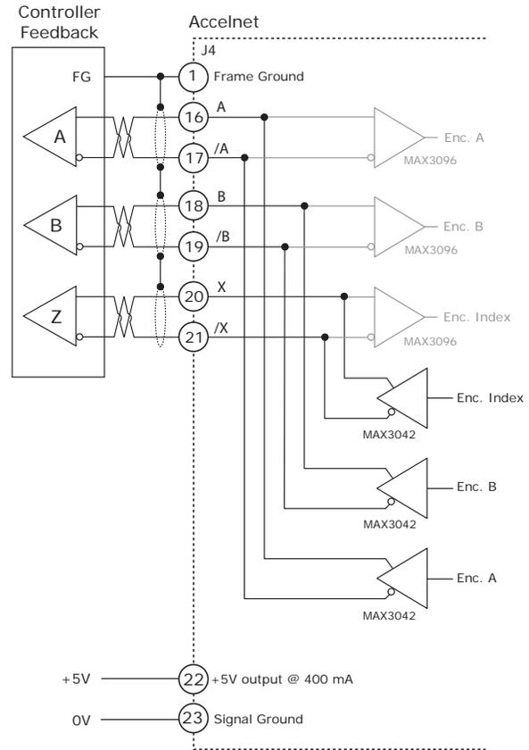
EMULATED QUAD A/B OUTPUTS FROM THE MOTOR ENCODER
