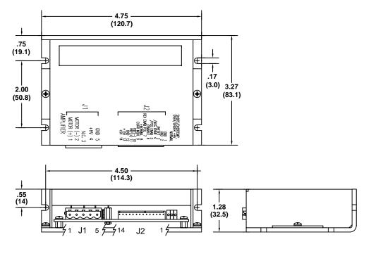
WEIGHT 0.52 lb ( 0.24 kg ) MATING CONNECTORS J1: Power & motor J2: Signal
